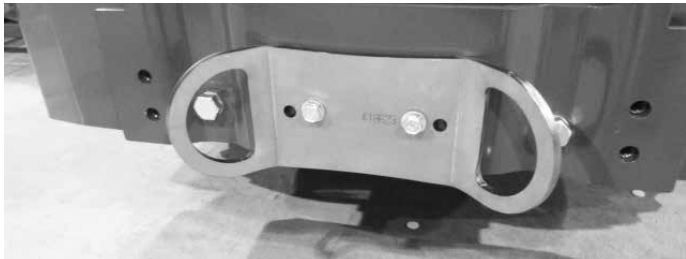
Zurrpunkthalterung A418623 am hinteren Stoßfänger oder Zusatzgewicht installiert
