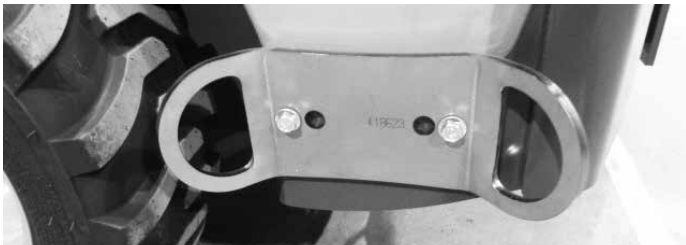
Zurrpunkthalterung A418623 seitlich am Hinterwagen installiert. Für die seitliche Montage sind zwei Halterungen erforderlich.
